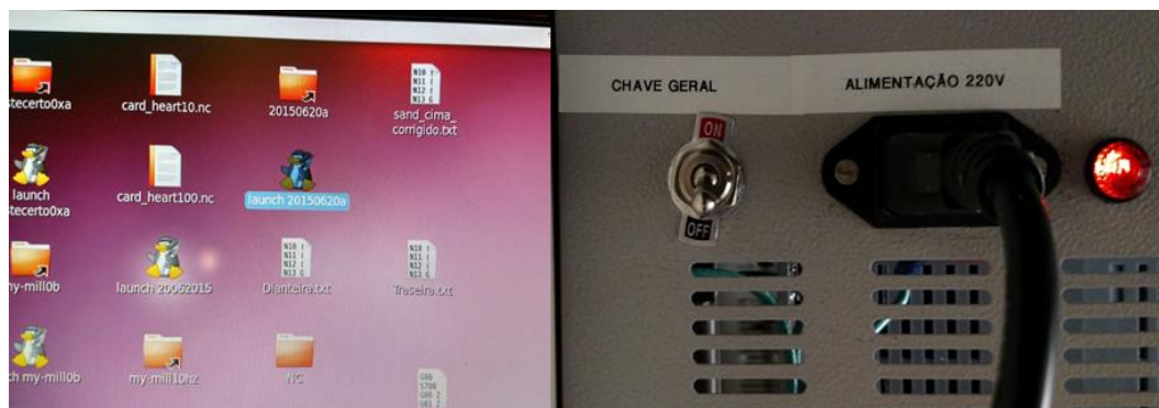
Figura 28 – Inicialização do LinuxCNC e região da alimentação geral, LED indicativo e chave do gabinete
