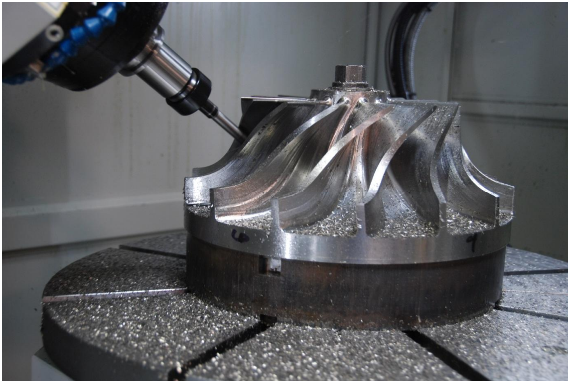
Figura 1 – Fresadora CNC de cinco eixos realizando uma usinagem de formato complexo [5]
